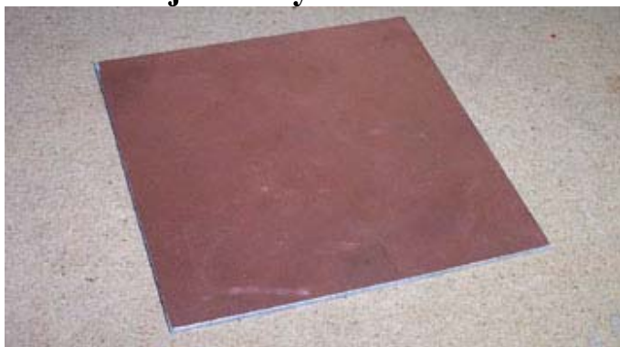
czysta płytki drukowana PCB miedziana o wymiarach: 110 mm x 110 mm (123x123)
